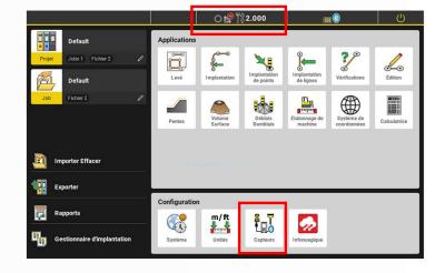
Dans Capteurs, appuyer sur la flèche à droite du ICG connecté.
