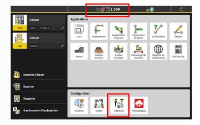
Dans Capteurs, appuyer sur la flèche à droite du ICG connecté.
